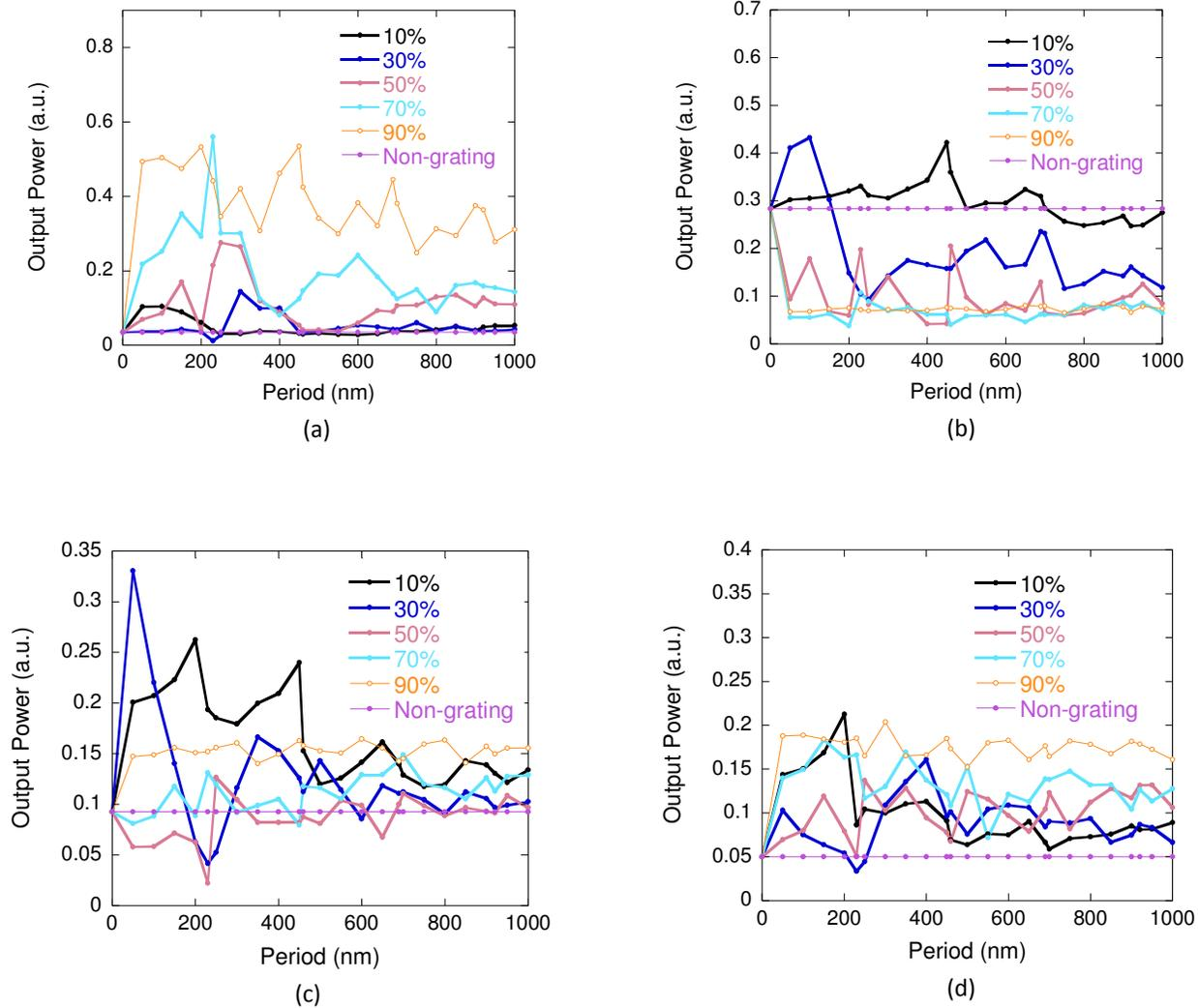
**Figure 3: Output power for the grating location case: (a)  $L=50\text{nm}$ , (b)  $L=200\text{nm}$ , (c)  $L=400\text{nm}$ , (d)  $L=600\text{nm}$**
