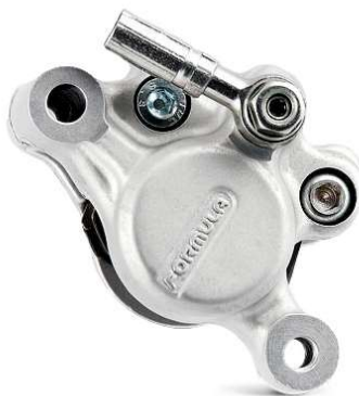
Figure 6. Formula mini moto caliper.
