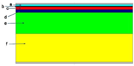
Figure 4 Conventional LED; a) p-GaN, b) MQWs, c) n-GaN, d) AlxGa1-xN, e) GaN buffer, f) Sapphire
