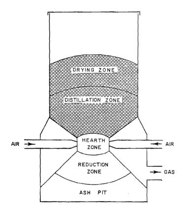
FIGURE I - DOWNDRAFT GASIFICATION
